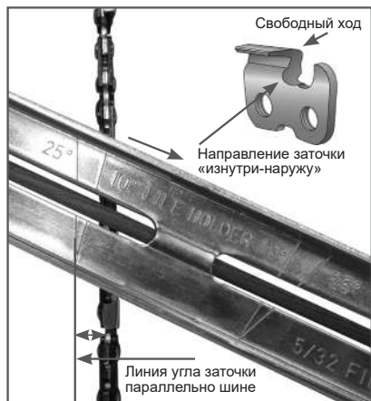
Рис. 26 Определение угла заточки
