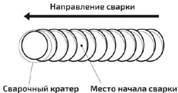
Рис. 11.2.2. Начало сварки при смене электрода.
