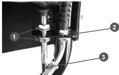
Рис. 11 Крепление оболочки троса включения хода
