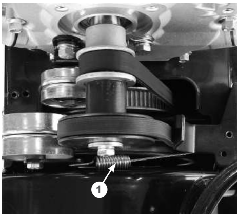
Рис. 9 Регулировка троса включения шнеков
