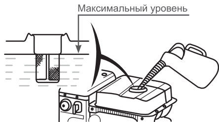
Рис. 31 Максимальный уровень топлива в топливном баке
