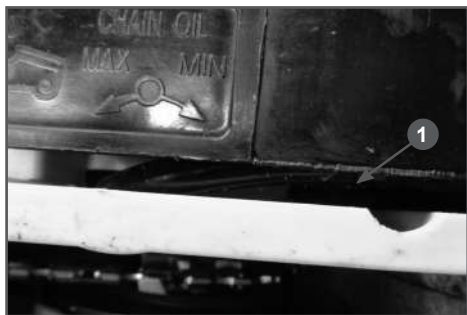
Рис. 8 Винт регулировки подачи масла 1. Винт регулировочный
