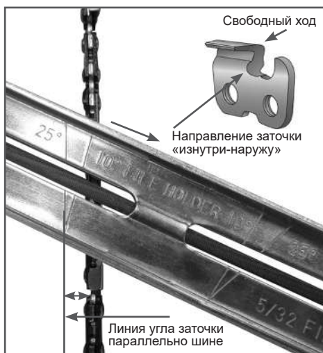
Рис. 23 Расположение линии угла заточки
