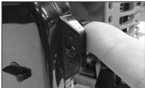
Рис.9 Закрытие воздушной заслонки
