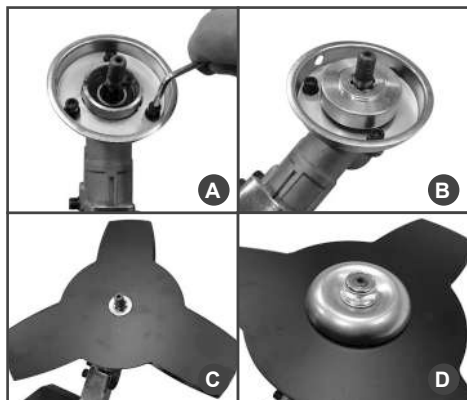
Рис.5 Установка ножа для травы
