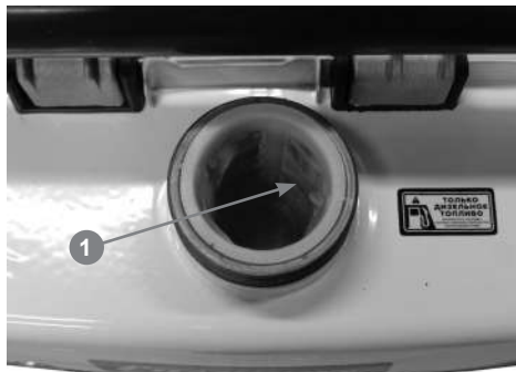
Рис. 9 Максимальный уровень топлива в топливном баке
