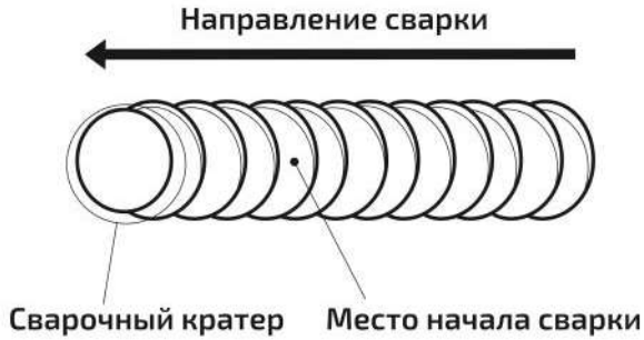
Рис. 9.1.2. Начало сварки при смене электрода.
