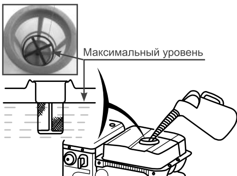
Рис. 8 Максимальный уровень топлива в топливном баке
