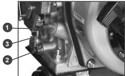
Рис. 10 Проверка уровня масла в картере
