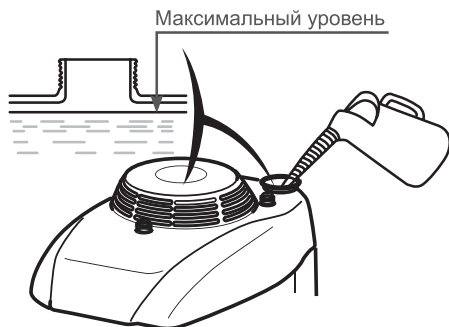
Рис. 7 Максимальный уровень топлива
