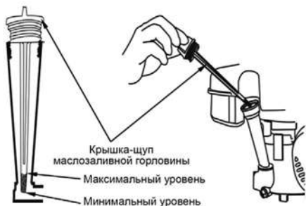
Рис. 9 Проверка уровня масла в картере
