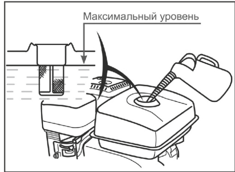
Рис. 19 Максимальный уровень топлива в топливном баке
