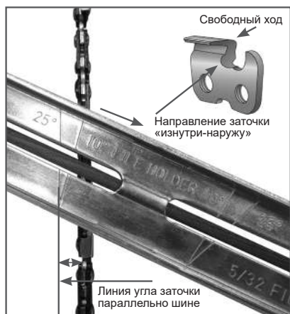
Рис. 37 Определение угла заточки
