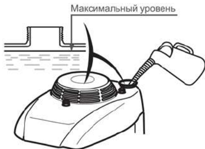
Рис. 8 Максимальный уровень топлива в топливном баке
