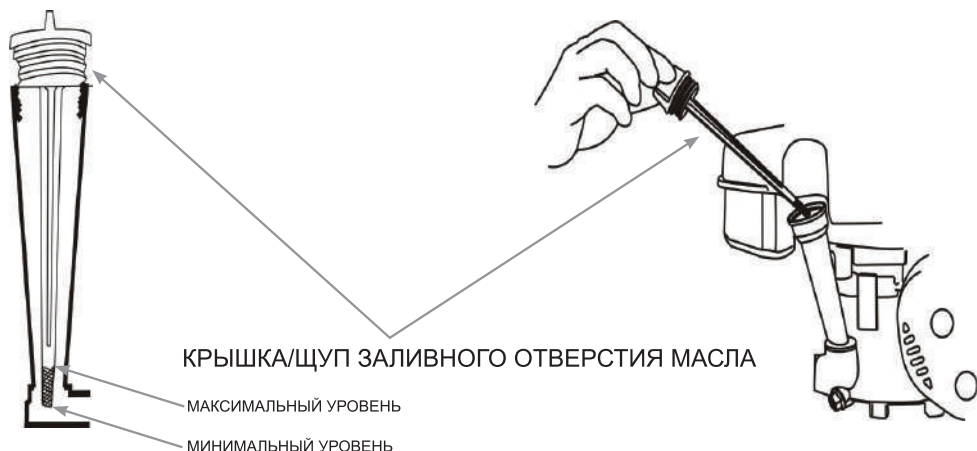
Рис. 10 Уровень масла в картере двигателя
