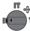
Pozycja do wiercenia bez udaru w drewnie, metalu, ceramice i tworzywie sztucznym, a także do wkręcania śrub
