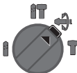
Posisjon Vario-Lock til innstilling av meiselposisjonen I denne posisjonen går slag-/dreiestopp-bryteren 13 ikke i lås.
