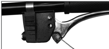
Рис. 9 Установка наконечника троса газа
