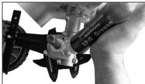
Рис. 24 Добавление смазки в корпус редуктора
