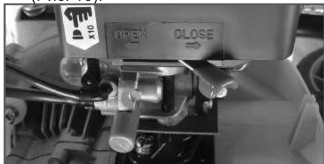
Рис. 16 Воздушная заслонка карбюратора закрыта
