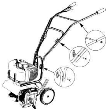
Рис. 8 Установка рукояток управления
