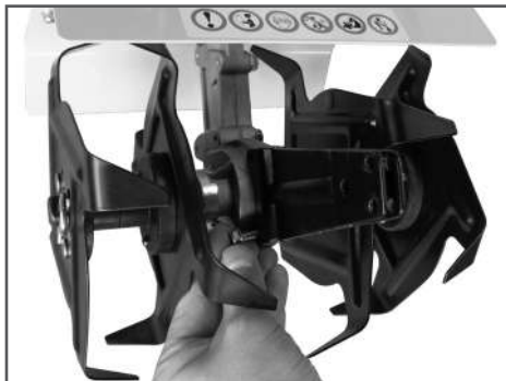
Рис. 5 Установка кронштейна сошника
