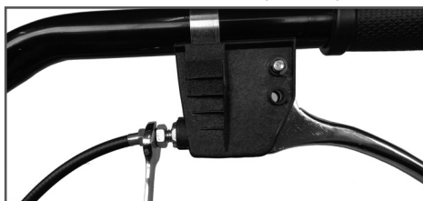
Рис. 10 Установка регулировочной муфты троса газа
