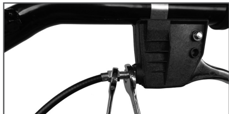
Рис. 12 Фиксация троса газа
