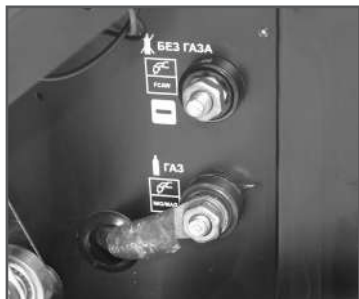
Рис. 10 Клеммы подключения кабеля механизма подачи проволоки
