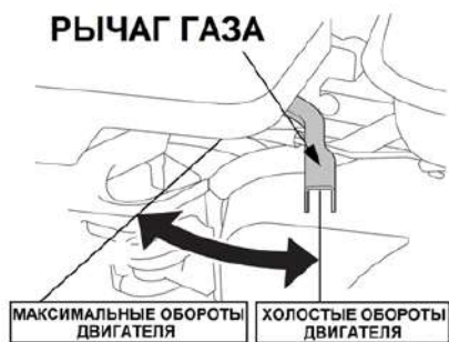
Рис. 15 Положения рычага газа
