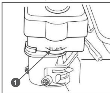
Рис. 32 Уровень масла в масляной ванне воздушного фильтра
