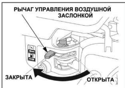
Рис. 24 Рычаг управления воздушной заслонкой
