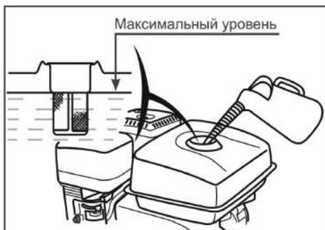
Рис. 22 Максимальный уровень топлива в топливном баке
