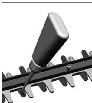
Рис. 3 Смазка режущих ножей
