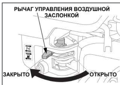
Рис. 27. Рычаг управления воздушной заслонкой
