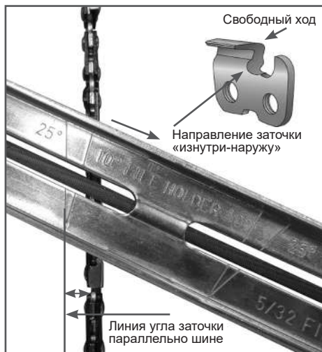
Рис. 16 Определение угла заточки
