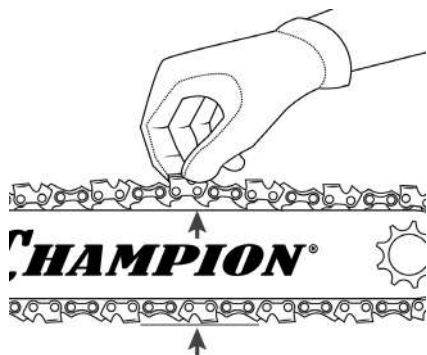
Рис. 4 Проверка натяжения цепи
