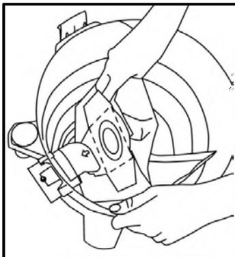
У пылесосов всех моделей фильтр HEPA фиксируется за счёт уплотнителя и силы всасывания.
