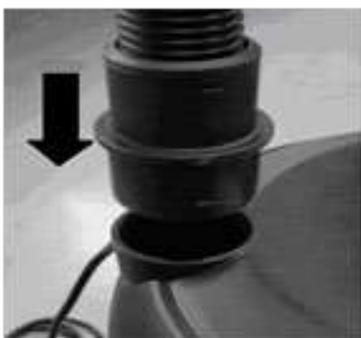
Вставьте раструб шланга в отверстие, расположенное в верхней части корпуса для уборки и сдувания сухих материалов с очищаемой поверхности.
