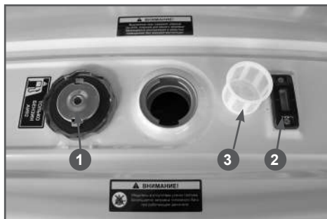
Рис. 3 Основные элементы топливного бака
