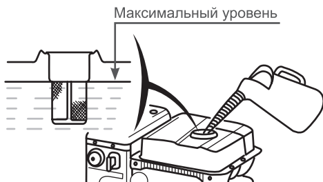
Рис. 2 Максимальный уровень топлива в топливном баке
