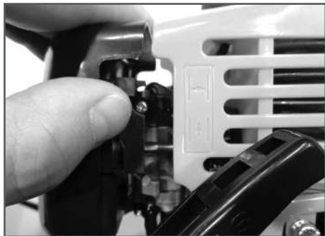
Рис.10 Закрытие воздушной заслонки
