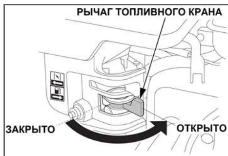
Рис. 13 Рычаг топливного крана
