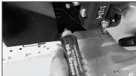
Рис. 25 Добавление смазки в редуктор
