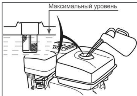
Рис. 12 Максимальный уровень топлива в топливном баке
