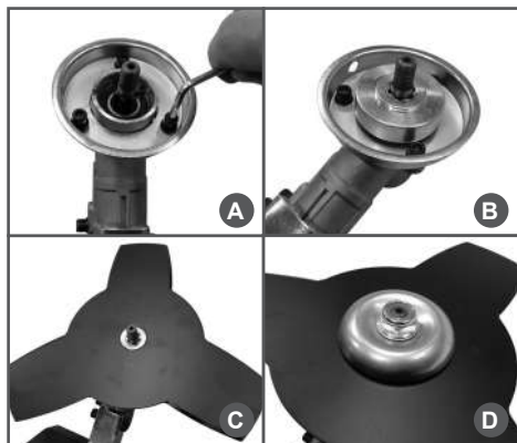
Рис.5 Установка ножа для травы
