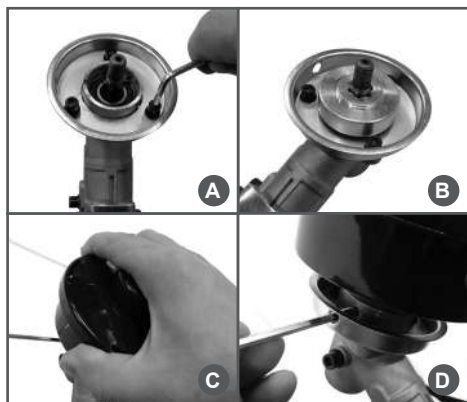
Рис.6 Установка триммерной головки
