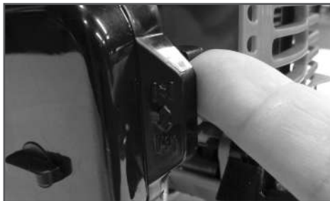
Рис.9 Закрытие воздушной заслонки
