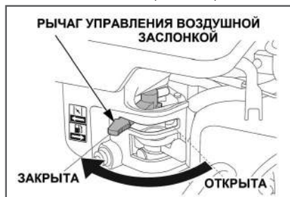
Рис. 15 Рычаг управления воздушной заслонкой PC6337F
