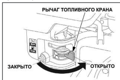
Рис. 16 Рычаг топливного крана PC6337F
