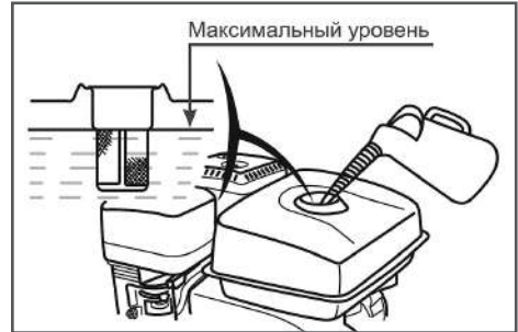
Рис. 13 Максимальный уровень топлива в топливном баке
