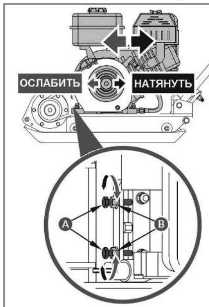
Рис. 31 Регулировка натяжения ремней РС6337F
