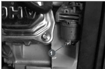
Рис. 24 Обслуживание фильтра-отстойника PC5332F
