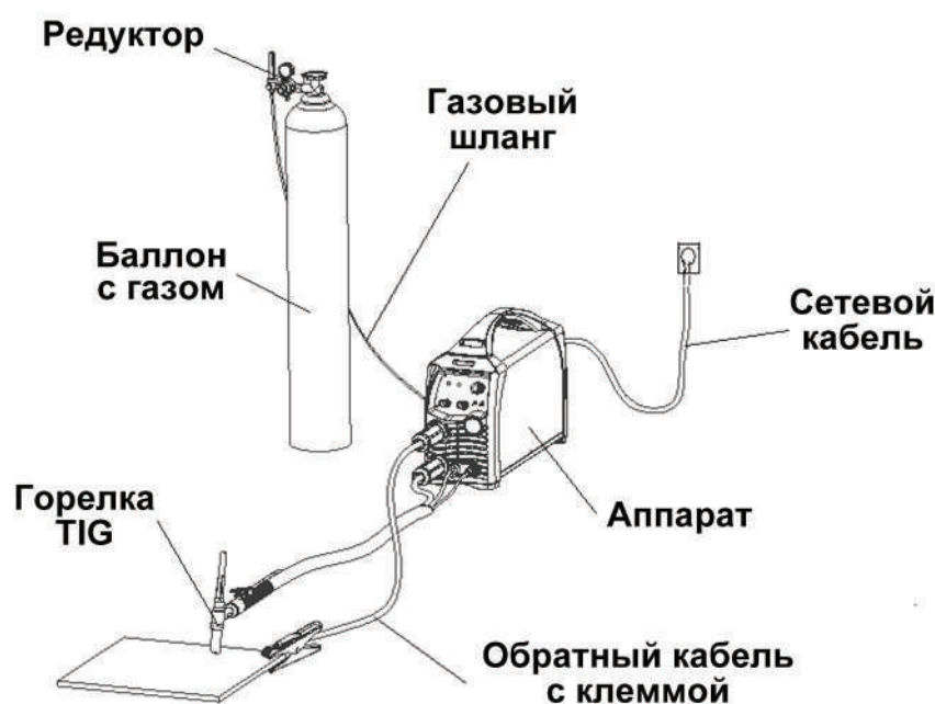
Рис. 6.2 Схема подключения оборудования для TIG сварки
