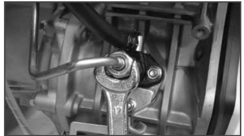
Рис. 12 Удаление воздуха из топливного насоса
