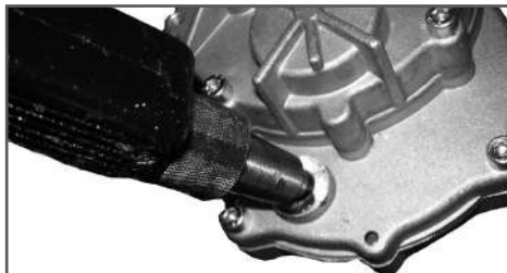
Рис. 15 Добавление смазки в корпус редуктора
