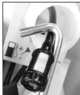
Рис. 12 Извлечение топливного фильтра
