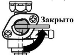
Рис. 7 Топливный кран закрыт
