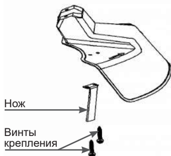
Рис. 2 Установка ножа для обрезки корда
