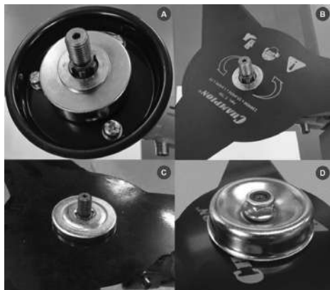
Рис. 7 Установка ножа для травы
