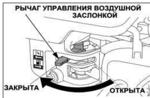
Рис.10 - Воздушная заслонка закрыта
