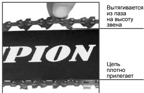
Рис. 6 Регулировка натяжения цепи
