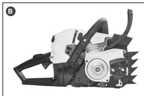
Рис. 3 Снятие крышки шины
