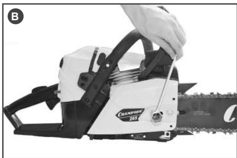
Рис. 5 Затяжка гайки крепления шины
