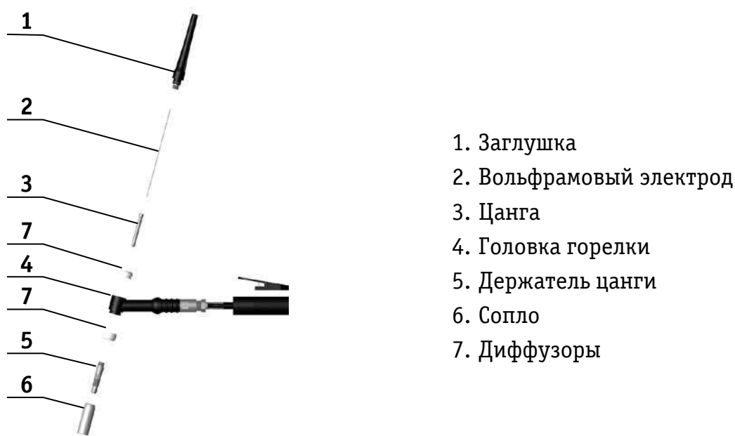
Рисунок 7.2.1 Основные компоненты горелки TIG
