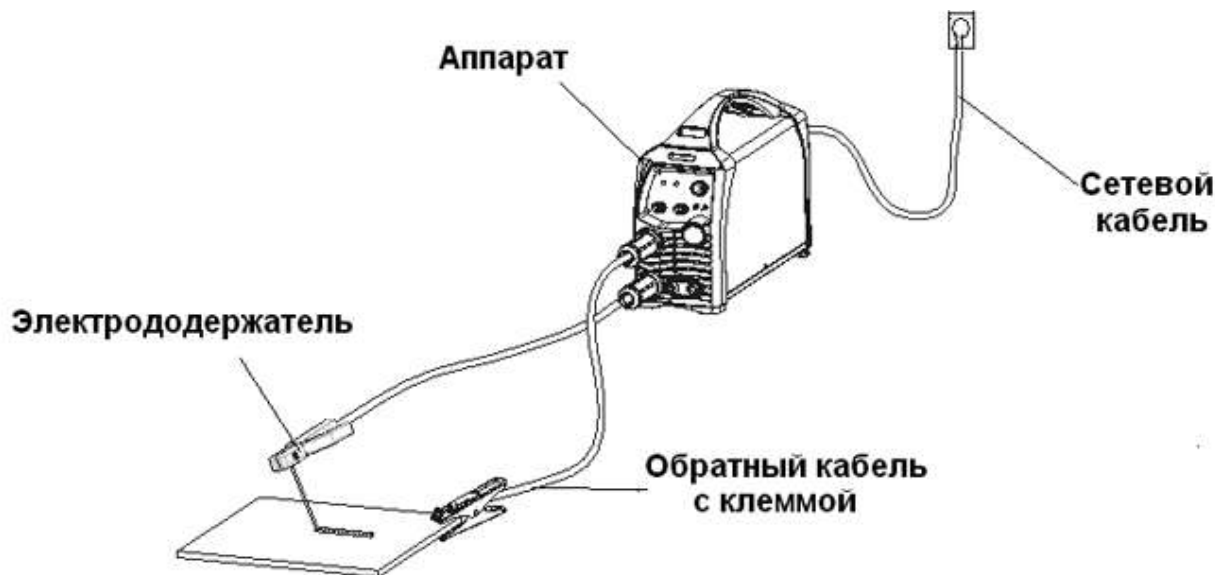
Рисунок 6.3 Схема подключения оборудования для ММА сварки.
