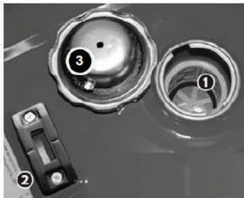
1 – сетчатый фильтр 2 – указатель уровня топлива в баке 3 – крышка топливного бака
