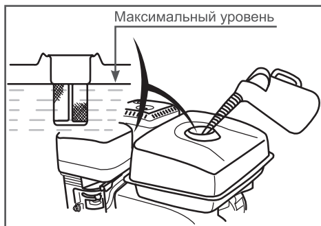
Рис. 24 Максимальный уровень топлива в топливном баке
