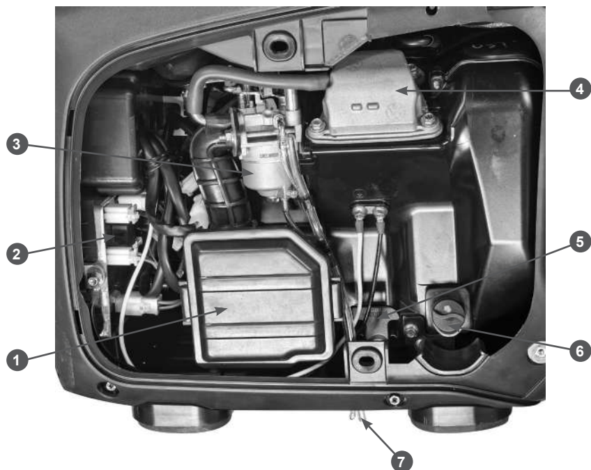
Рис. 3. Основные узлы и органы управления (вид со снятой правой панелью)
