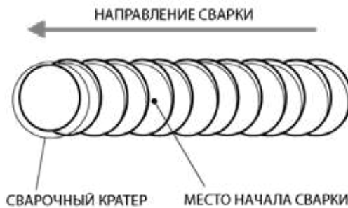
Рис. 11.2.2. Начало сварки при смене электрода.
