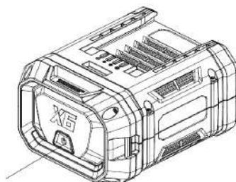
Кнопка активации индикатора остаточного заряда
