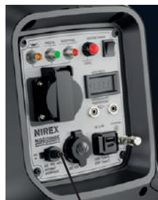
Автомат защиты DC
