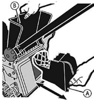
Рис. 15 Установка заглушки для мульчирования
