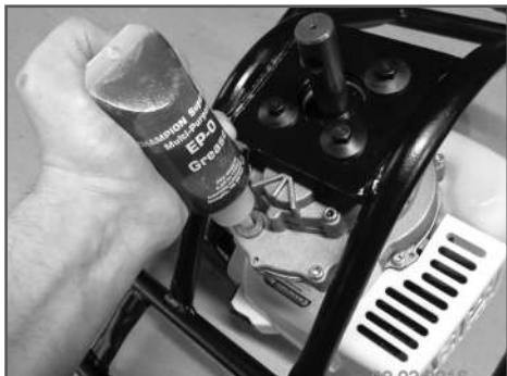
Рис. 15 Добавление смазки в корпус редуктора
