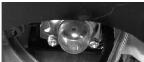
Рис. 5 Ручной топливный насос
