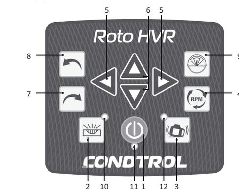
1. Включение/выключение прибора
