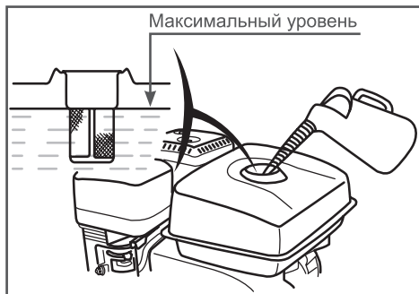
Рис. 23. Максимальный уровень топлива в топливном баке
