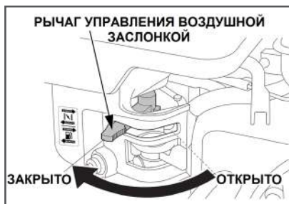
Рис. 27. Рычаг управления воздушной заслонкой
