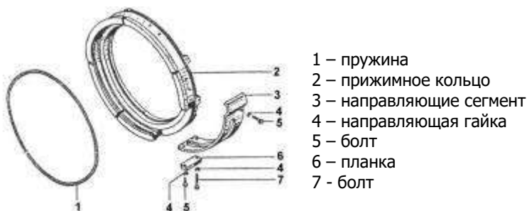
Рисунок 6. Канатоукладчик – развернутый вид.
