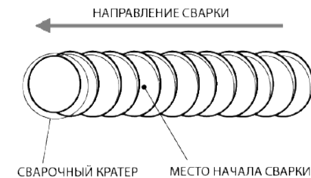
Рис. 9.4. Начало сварки при смене электрода.
