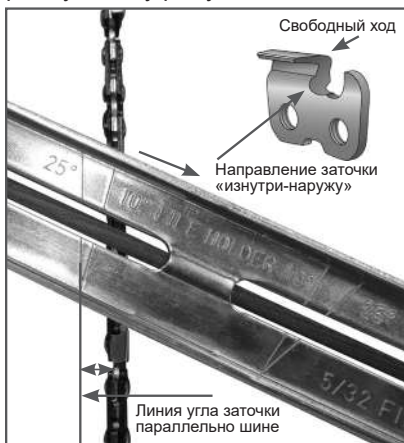
Рис. 19 Определение угла заточки
