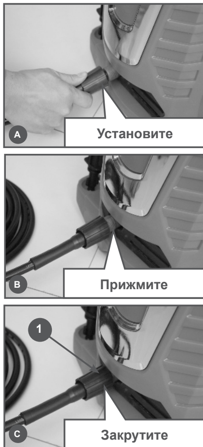
Рис. 4 Подключение шланга высокого давления
