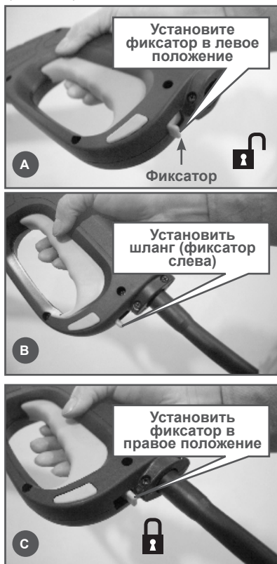
Рис. 3 Подключение шланга высокого давления к пистолету
