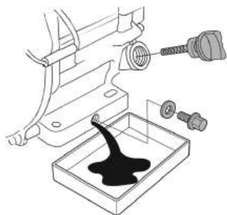
Рис. 24. Замена масла в двигателе
