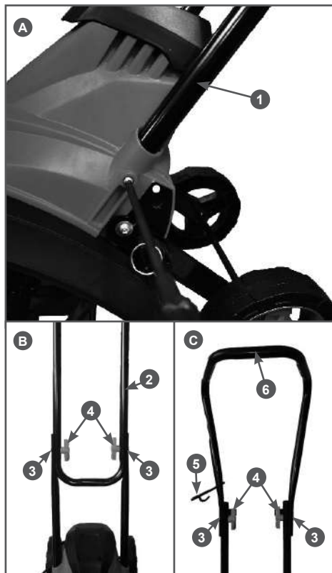
Рис. 4 Установка рабочей рукоятки
